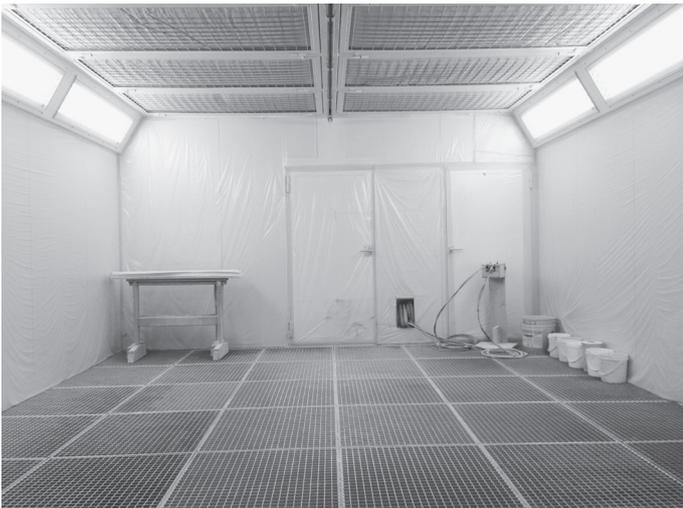
Um den sehr hohen Anforderungen in der Oberflächenqualität und der grossen Vielfalt der unterschiedlichsten Produkte gerecht zu werden, wurden von der New Wälti AG in 8400 Winterthur eine kombinierte Farbspritz- und Trocknungskabine sowie eine separate Ablüft- und Trocknungskabine System WältiKOMPAKT mit einer Handschiebebahn konzipiert.
