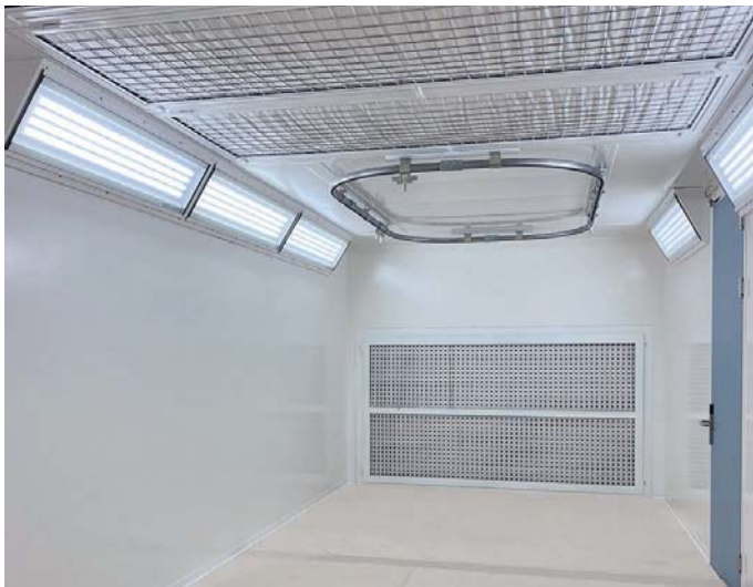
Kombinierte Farbspritz- und Trocknungskabine mit LED-Beleuchtung.
